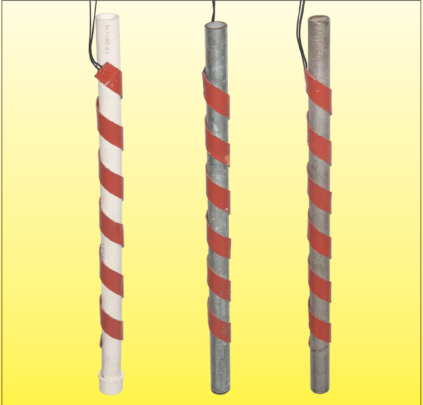
Bedingungen der Vergleichstests: Silikonheizbänder gewickelt auf Rohre mit einem Außen-Ø von 25mm, aus PVC-U, verzinktem Stahl und Edelstahl
