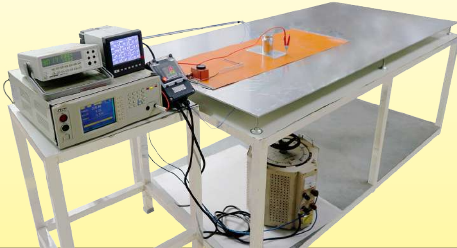
Messgeräte für den Gesamtleckstrom im heißen Zustand
